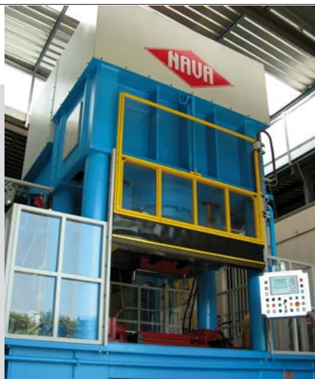
Pressa oleodinamica da 8.000 kN della F.lli Nava, sviluppata per la chiusura con movimento verticale della metà superiore dello stampo, di un gruppo moltiplicatore di pressione
