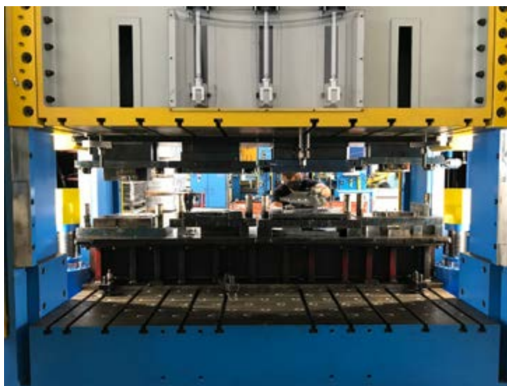
La nuova pressa oleodinamica della F.lli Nava è in grado di erogare 450 ton di forza, oltre a disporre di un prelamiera da 200 ton, ovvero una tavola unica con 4 punti di regolazione liberamente programmabili a livello elettronico
