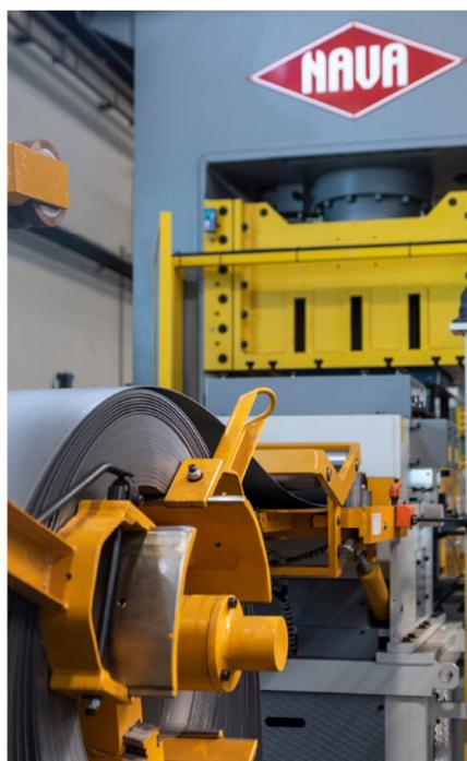
Dettagli su integrazione con caricamento mediante aspo
