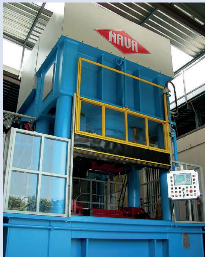
Pressa per idroformatura di famiglie di tubi di grande formato, tipicamente scarichi per il settore moto, progettata e realizzata dalla F.Ili Nava.
