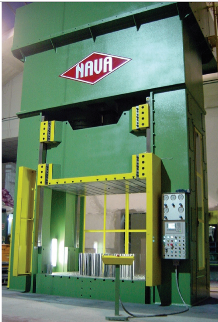
Fig. 2 - Pressa 2MI 1200/500 di F.lli Nava Srl, per imbutitura classica o con azione dal basso, regolazione premilamiera su cinque punti di spinta.
