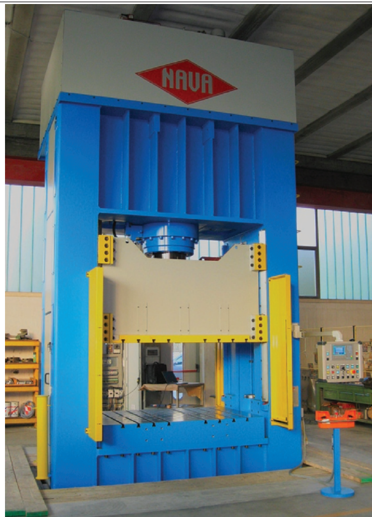
Fig. 3 - Pressa 2MI 500/300 di F.lli Nava Srl, per imbutitura classica e con azione dal basso con funzione estesa, regolazione premilamiera su quattro punti di spinta.
