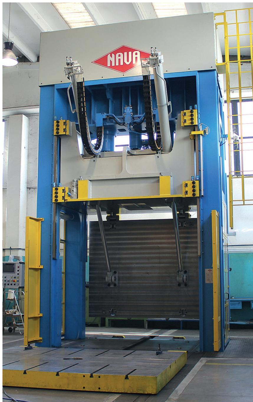
Pressa oleodinamica prova stampi a due montanti realizzata dalla F.lli Nava per un cliente italiano operante nel settore automotive.
