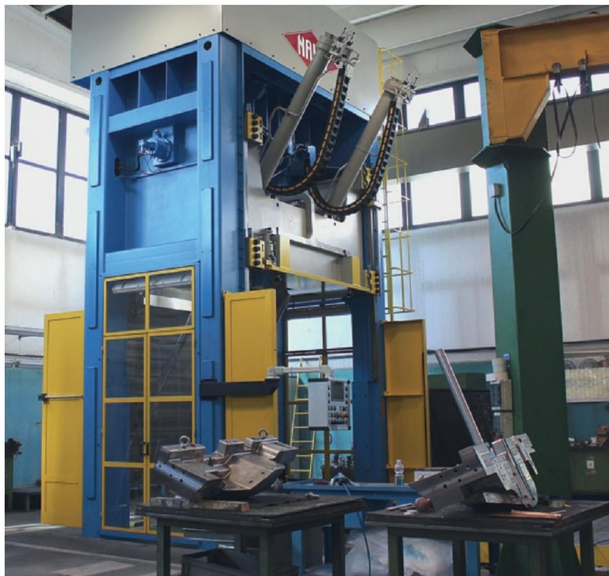
**Vista con una diversa prospettiva della macchina, dove è possibile valutare la consistenza delle soluzioni costruttive strutturali adottate per la massima rigidità della pressa.**
