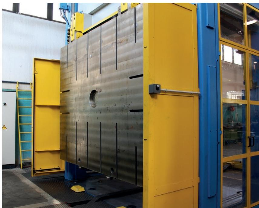
**Piano basculante sotto la mazza della pressa ruotato di 90 gradi.**
