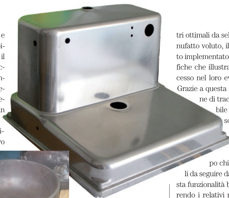
Vasca in inox e uno stampato grande spessore realizzati con le nuove presse della ditta Nava.
