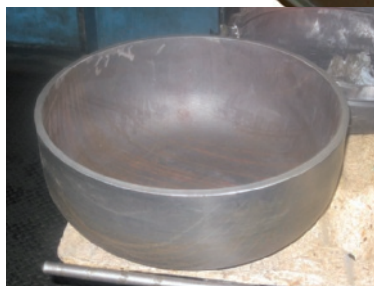
Vasca in inox e uno stampato grande spessore realizzati con le nuove presse della ditta Nava.
