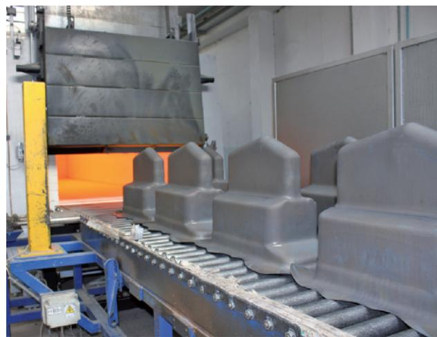
Il parco macchine di Steel Form Group comprende anche due forni di ricottura.
